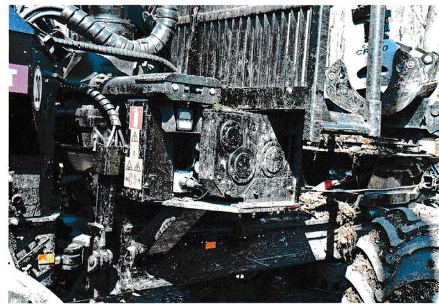
Oben: Die seitlich der Prallwand montierte Adler-Winde zieht zehn Tonnen. Unten: Das ausgehängte Heck und die mittlere Rungenbank werden auf dem Firmenhof zwischengelagert.
