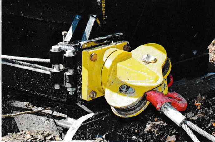
Rechts: Das Heck der Maschine ist ausgehängt, nur die Verschlussplatte noch nicht angeschraubt. So ist der Logset recht kompakt. Seitlich unter der Klemmbankbasis sitzt der Seileinlauf. Dieser läßt sich aber über ein Stecksystem versetzen. Werden zwei Schrauben gelöst (oben), kann der Seileinlauf unter die Prallwand (hier folgt die Aufnahme in Kürze) oder an das Heck montiert werden – je nachdem, wo das Seil benötigt wird.
